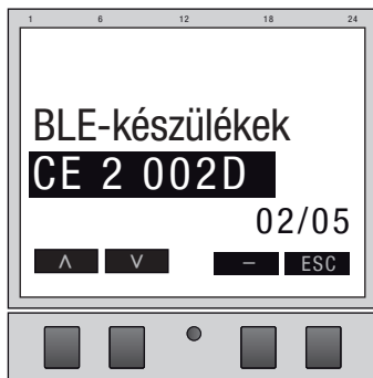
25. ábra: Csatornabővítés kiválasztása
